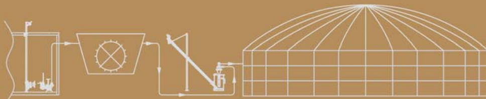
Annahmehunker — Hammermühle — CycloSort — Biogasanlage
